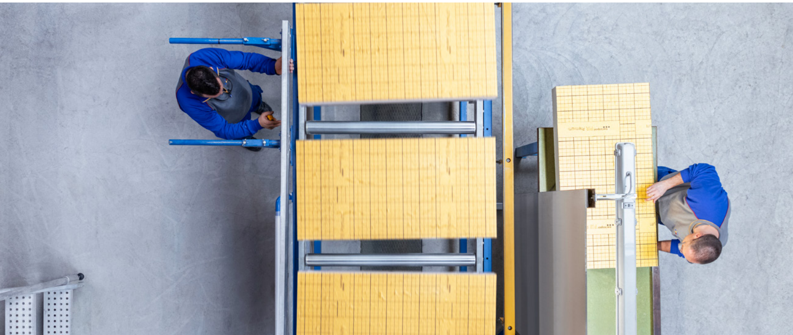
Die Dämmstoffplatten werden bei swisspor individuell nach Kundenauftrag zugeschnitten Bildquelle: swisspor AG
